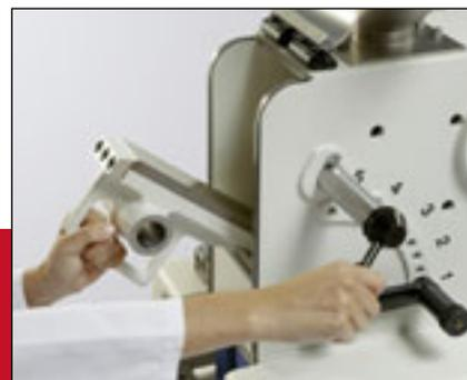
Экономит время и работу: извлечение дробящих плит из дробилки для проведения очистки камеры дробления выполняется двумя простыми движениями руки за несколько секунд.
