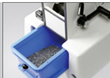
Мощное дробление: грубую базальтовую породу PULVERISETTE 1 (модель I) измельчает в положении зазора 2 до конечной степени измельчения, показанной в приемной емкости справа.
