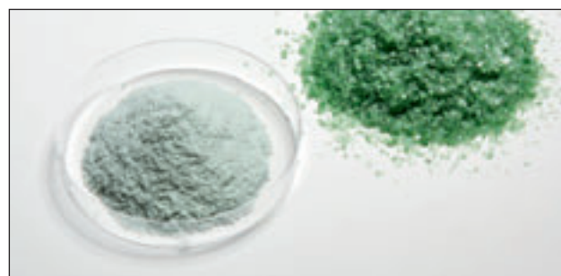
Стекло до и после измельчения на планетарной мельнице PULVERISETTE 7 premium line .
