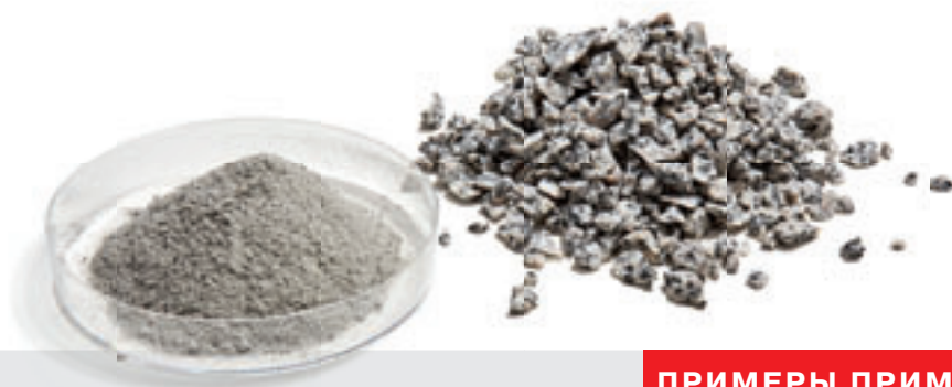
Измельчение гранита на планетарной мельнице PULVERISETTE 7 premium line
