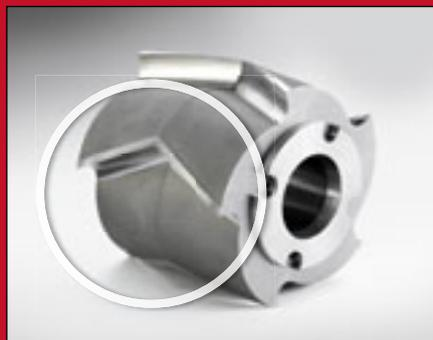
Стандартный ротор из инструментальной стали с V-образными лезвиями и неподвижными ножами, благодаря особенно острому углу лезвий и более высокому режущему эффекту, подходит, прежде всего, для измельчения вязко-эластичных материалов и пленок. Для жестких и твердых материалов хорошо подходит ротор с V-образными лезвиями и неподвижными ножами из твердосплавного карбида вольфрама, который измельчает материал за счет ударного и режущего эффекта.
