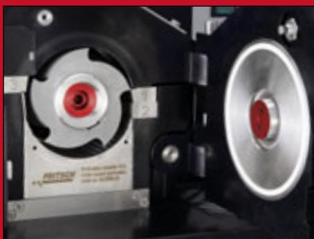
**Патент FRITSCH** В режущих мельницах FRITSCH P-19 и P-25 ротор установлен на двойных подшипниках с коническими роликами – на валу и в крышке. Это обеспечивает стабильный ход, минимальный износ и увеличенный срок службы Вашей мельницы. В модели P-15 ротор также установлен на двойных подшипниках.
