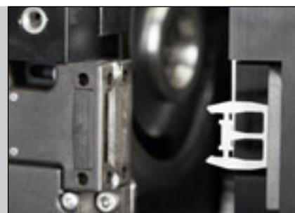
Закрывается особенно надежно: стопорная защелка камеры измельчения.
