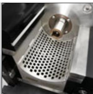
Большая глубина камеры измельчения для проб большого объема
