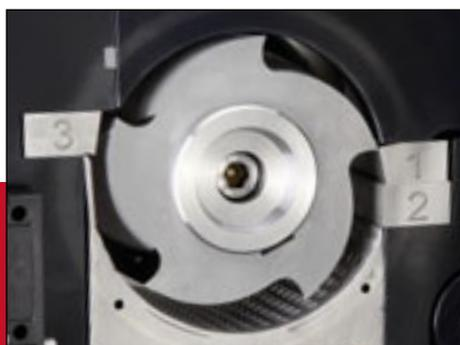
Уникальная геометрия камеры измельчения мельницы: камера измельчения в режущих мельницах FRITSCH отличается минимальным мертвым объемом и прогрессивной геометрией резки между ротором и неподвижными ножами – для более быстрой и простой работы.
