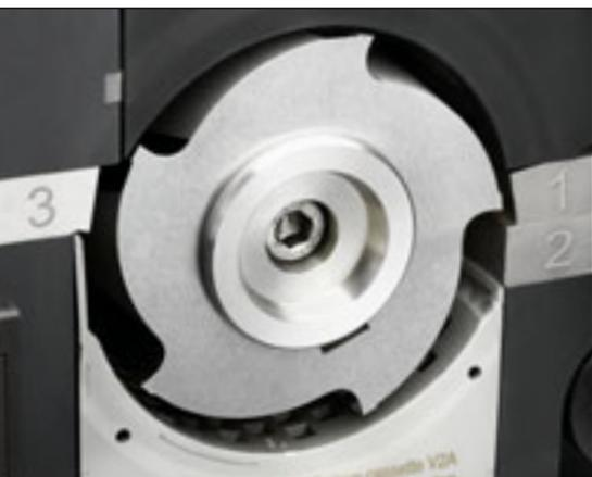
Прогрессивная геометрия резки между ротором и неподвижными ножами обеспечивает быстрое измельчение и надежную защиту от закупоривания.
