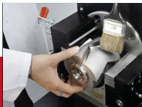
Ротор в открытом для очистки режущих мельниц FRITSCH легко проворачивается рукой и извлекается без использования инструментов.
