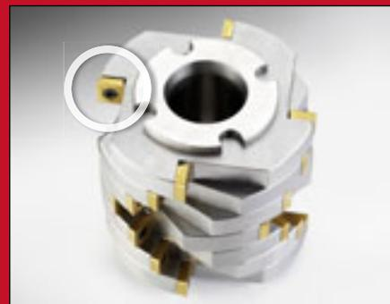
Особо прочный ротор с дисковой фрезой со сменными режущими пластинами и неподвижными ножами из твердосплавного карбида вольфрама измельчает даже лом печатных плат с остатками стекловолокна и медный кабель. Еще одна хорошая идея от FRITSCH: в роторе с дисковой фрезой режущие пластины можно 4 раза повернуть и индивидуально заменять. Повреждение или износ в будущем не станут причиной полной замены ротора на новый!
