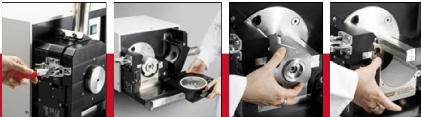
В то время, как в других мельницах завинчиваются винты, Ваша режущая мельница FRITSCH уже очищена. Это так, потому что вся камера измельчения легко открывается за несколько секунд, а ротор и ситовая кассета извлекаются простыми движениями. Корпус камеры измельчения и ее крышку можно полностью откинуть, а крышку просто снять с петель.
