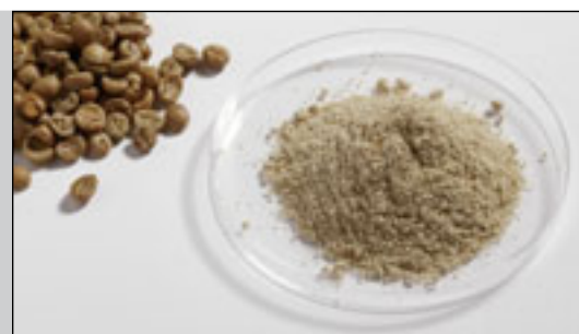
Сырой кофе перед измельчением и после измельчения в Р-14 с кольцевым ситом с 1 мм трапециевидной перфорацией при 20000 об/мин
