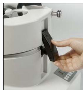
Автоматическое аварийное отключение при открывании
